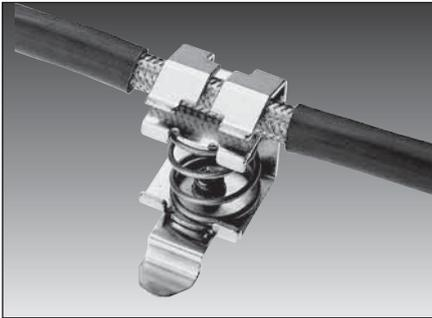
La brida de apantallamiento se puede utilizar en todos aquellos sitios en los que el apantallamiento de los diferentes cables haya de conectarse con el potencial de masa. La brida SK se sujeta con un tornillo a la placa de montaje o, con el pie de montaje, en un carril omega de 35 mm.
