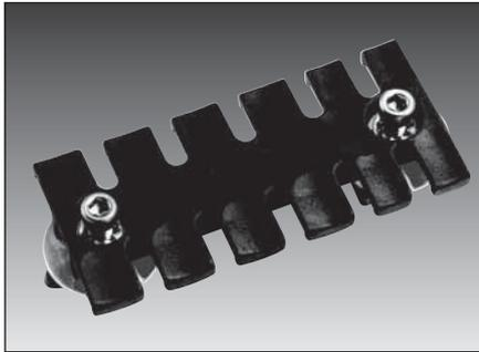
El perfil sujetacables ZL-AM está basado en el perfil sujetacables ZL. Las arandelas de latón introducidas a presión en el perfil impiden que el plástico se deforme a causa de vibraciones fuertes y permanentes, y que por lo tanto la unión atornillada se suelte por sí sola. Las tuercas correderas y tornillos están fabricados en acero inoxidable. De fácil montaje en carriles C con una ranura de 16 mm y una anchura interior de 22 mm - 27 mm.
