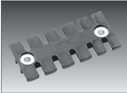
El perfil sujetacables ZL-AH está basado en el perfil sujetacables ZL. A través de los casquillos de aluminio es posible utilizar tornillos M5 normales para sujetar el perfil. También es posible sujetar el perfil sujetacables con remaches.
