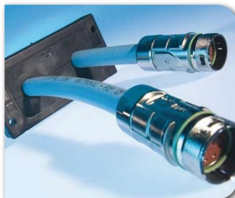
La placa pasacables tipo KDL/S es una placa pasacables especial que permite introducir diferentes cables de acuerdo con los deseos del cliente y cerrar aberturas. El manguito interior KDT/S puede ser diseñado de acuerdo con los deseos del cliente. Adecuados para recortes estándar para conectores de 16 polos, por ejemplo Harting, Wieland y Rittal
