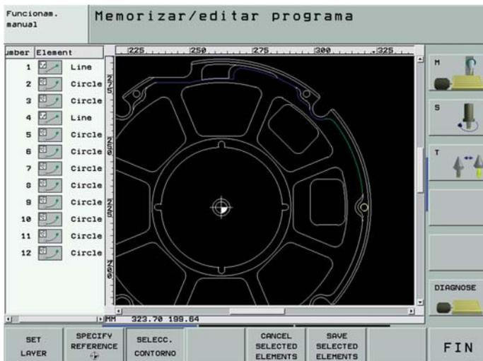
Función de zoom sobre los detalles de un fichero DXF importado
