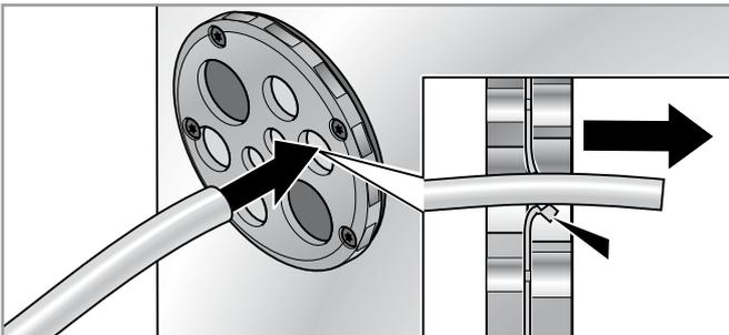
Elegir un orificio que se ajuste al diámetro del cable y empujar el cable por delante a través del orificio. En la parte trasera de la KDP/R se puede ver el indicador. Tirar de los cables hasta la longitud deseada.
