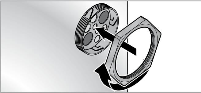
Hacer un recorte circular que se ajuste al KDP/R. Colocar la placa pasamuros y presionar. Fijar la KDP/R con la contratuerca.
