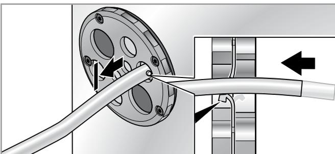
Empujar el cable aprox. 10-15 mm hasta que el indicador en la parte trasera deje de estar visible. En función del diámetro del cable y del tamaño del orificio puede quedar visible de nuevo el indicador en la parte delantera.
