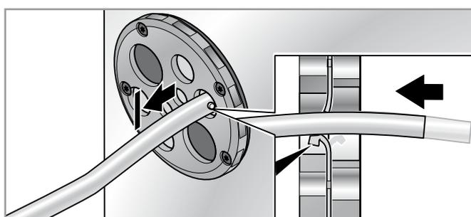
Empujar el cable aprox. 10-15 mm hasta que el indicador en la parte trasera deje de estar visible. En función del diámetro del cable y del tamaño del orificio puede quedar visible de nuevo el indicador en la parte delantera.
