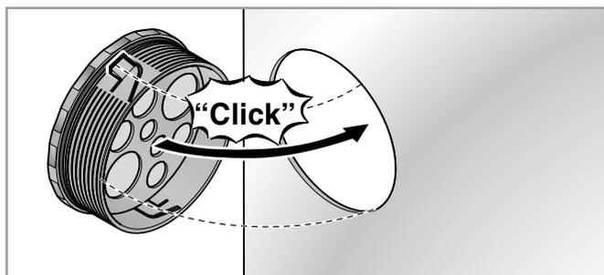
Hacer un recorte circular que se ajuste al KDP/R. Colocar la placa pasamuros y apretar hasta que encaje en el recorte.
