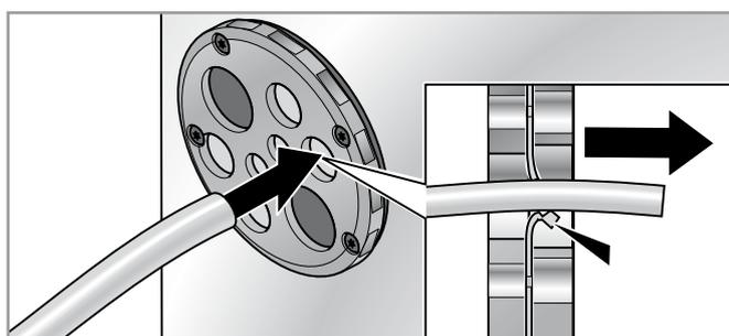
Elegir un orificio que se ajuste al diámetro del cable y empujar el cable por delante a través del orificio. En la parte trasera de la KDP/R se puede ver el indicador. Tirar de los cables hasta la longitud deseada.
